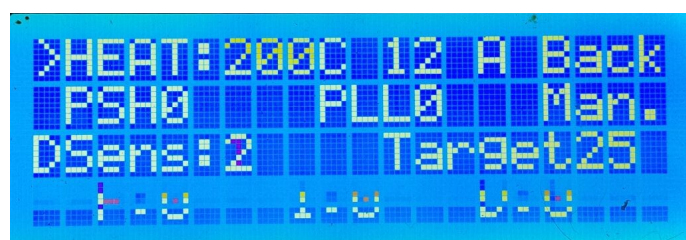
Control panel. Last row : "P:0 I:0 D:0"
