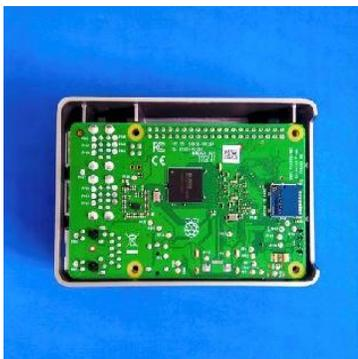
Remova o outro lado do filme plástico do thermal pad coloque o Raspberry Pi com a face voltada para baixo na case. A maneira mais fácil de colocar o Raspberry Pi na Flirc Case é começar com o lado que possui a conexão HDMI.
