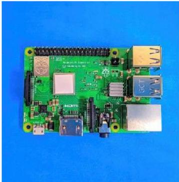
Agora você tem que colocar o thermal pad correto no processador do Raspberry Pi, então remova um lado do filme plástico primeiro e coloque em cima do processador do raspberry Pi.
