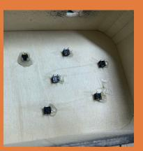
PLACE A PUSHBUTTON THROUGH SEVEN OF HOLES DRILLED ON STEP 1\*. WHEN YOU FOLD THE HINGE, THE GRAVE MUST FALL ON TOP OF THE PUSHBUTTON.
