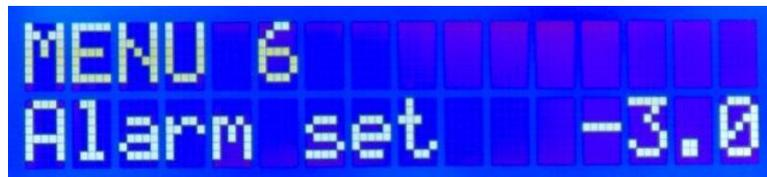
Ajustar el valor de umbral para la activación de las alarmas de sonido y luces en un evento de caída. El valor es seleccionado de una lista {OFF, -2.5, -3.0, -4.0, -5.0} presionando brevemente el "Botón 3". El valor inicial luego de encender el dispositivo es de -3.0 m/s.
