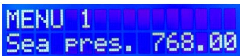
Este ítem del menú muestra el valor de la presión atmosférica a nivel del mar (QNH) requerido para calcular la altitud absoluta
