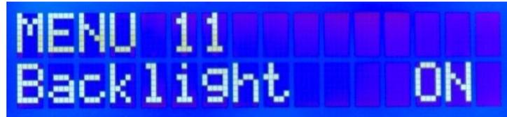
Enciende o apaga el backlight del LCD. El valor ON/OFF es seleccionado presionando brevemente el "Botón 3". El valor inicial está ajustado a "ON" cuando el dispositivo es encendido.
