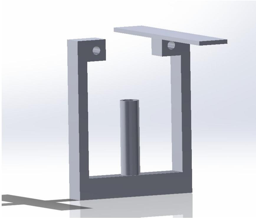
Este mecanismo es el encargado de que la jeringa se mueva en el eje Y. El cilindro central es la parte en donde se coloca la jeringa, mientras que el rectángulo que se encuentra en la parte de arriba sirve como base para la cremallera.
