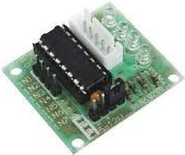
Para control de los motores 28byj-48 se utilizaron drivers 2ph64011a que a través de 4 pines de entrada, dictan las bobinas del motor a pasos a energizar. Dado que el GRBL entrega una señal de control en 2 pines (pasos, dirección) se utilizó un segundo arduino a modo de driver que manejara a través de interrupciones los cambios en el estado de cada motor, así como un manejo especial de la cabeza de impresión dado que se requería solo del control de los estados activado y desactivado.
