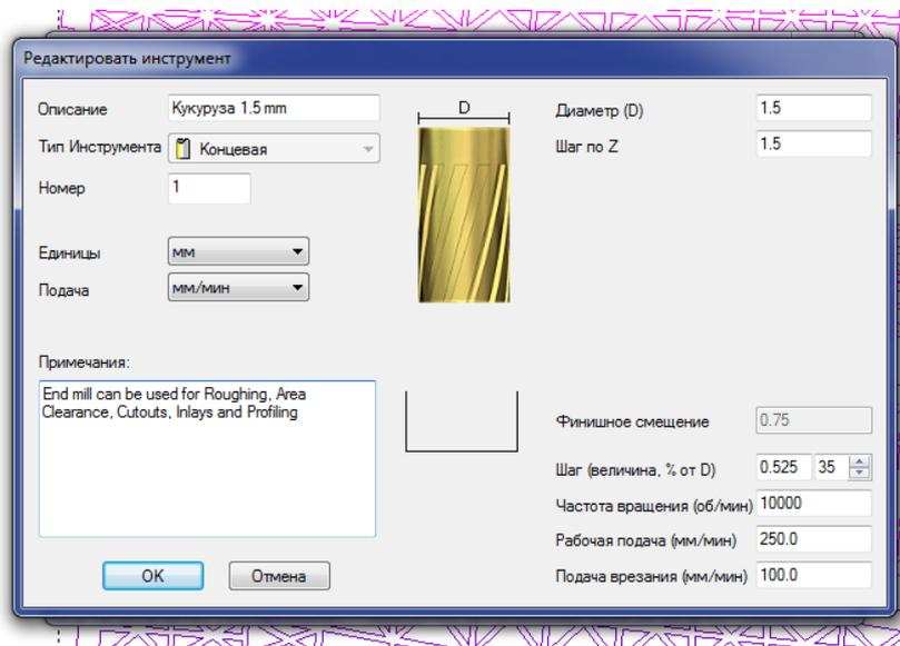
Figure 16 – Cutter parameters «Corn».
